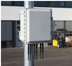
Bild 4: IWL3000 Serie im robusten IP65-Schutzgehäuse inkl. WLAN-Antennen der Schutzart IP67
