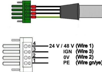
Das Gerät kann über das Zündungssignal (Ignition) hoch- und heruntergefahren werden. Die Funktion dient zur Sicherung des Systems gegen Fremdzugriff und hat zugleich eine energiesparende Wirkung auf die versorgende Batterie.
